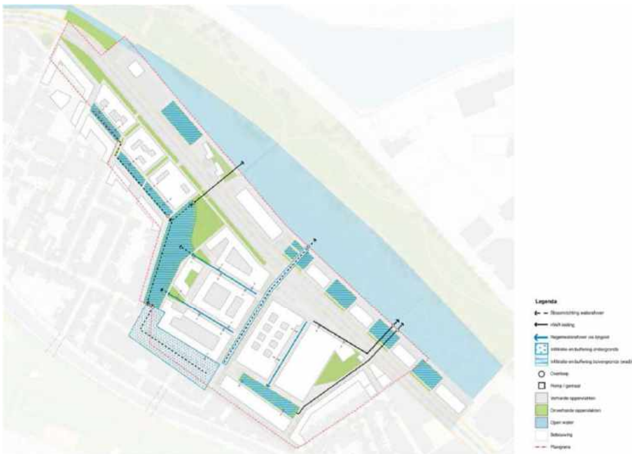
Figuur 5-52 Voorzien waterinfiltratie en –afvoersysteem (bron: Masterplan)
