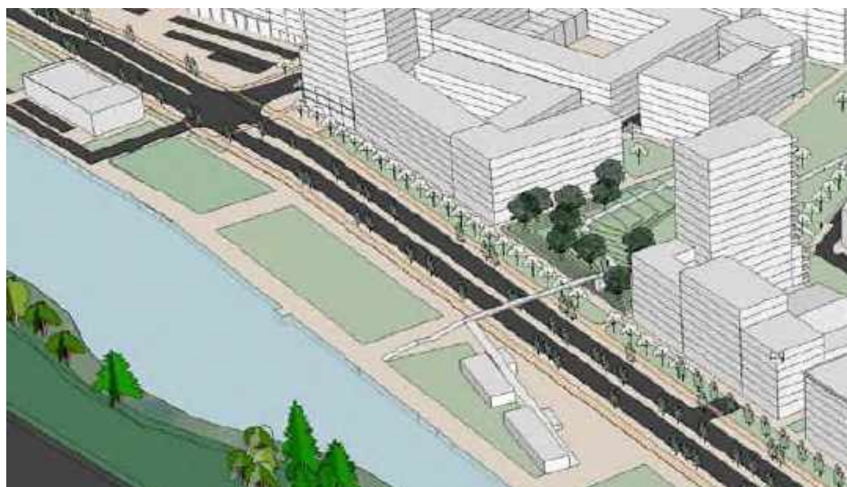
Figuur 5-13 Beveiligde oversteekplaats t.h.v. Oude Kalverstraat en passerelle t.h.v. Kalverwei
