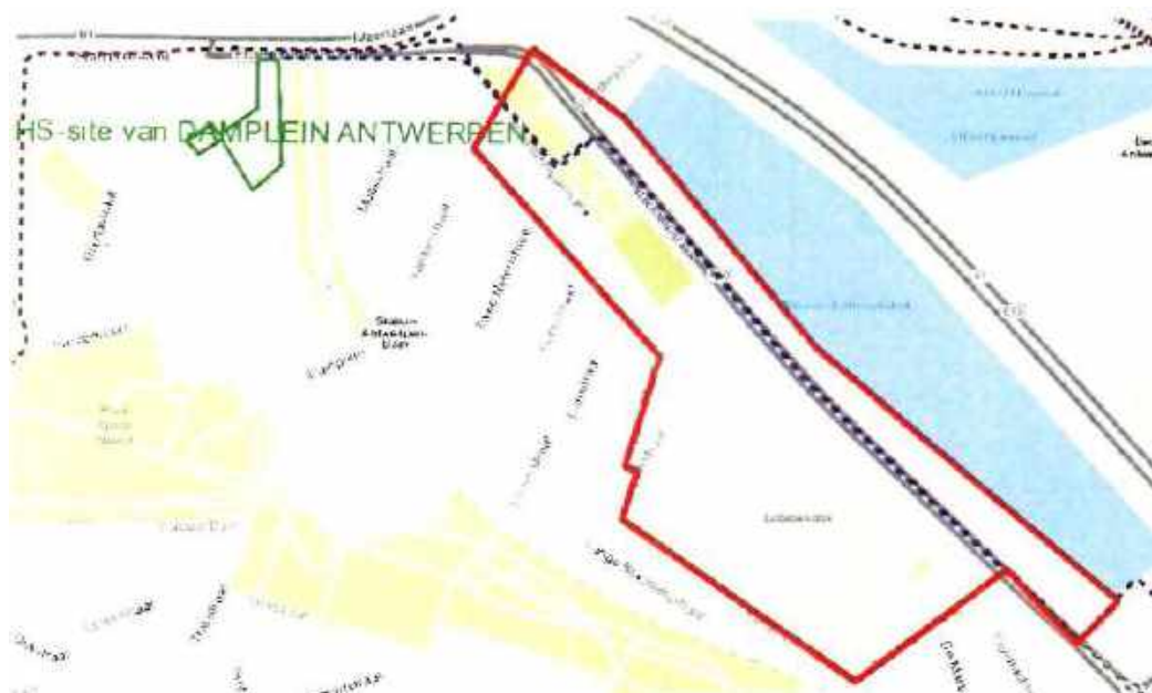
Figuur 5-63 Tracé ondergrondse hoogspanningsleiding van Elia doorheen het plangebied
