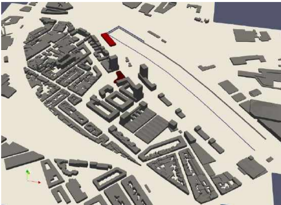
Figuur 5 : Overzicht van de geometrie van het ow100 scenario met behoud van de loods (rood), de aangebrachte talud (donkerrood) en waarbij het viaduct van Merksem vervangen is door een brede sleuf, 7 m onder het maaiveld ter grootte van de beide rijrichtingen.
