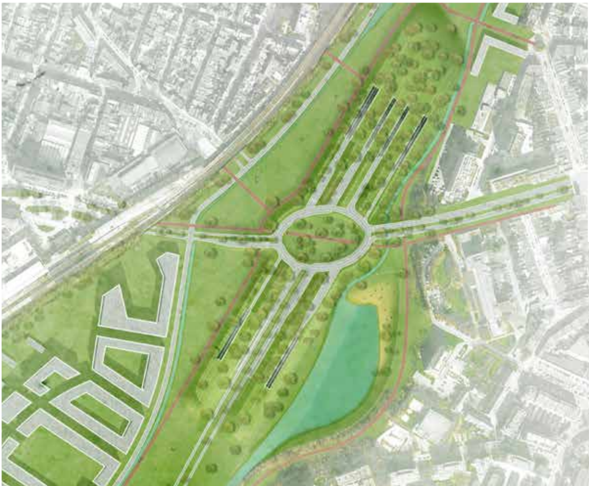
↑ De turborotonde is het infrastructuurconcept dat de grootste capaciteit kan verwerken. Het is hier toegepast op het drukste kruispunt (Plantijn en Moretuslei). Een sterke landschappelijke integratie kan ook dit deel van Ringland een eigen karakter geven (meer heuvelachtig en bebost bijvoorbeeld) (afbeelding door OMGEVING)
