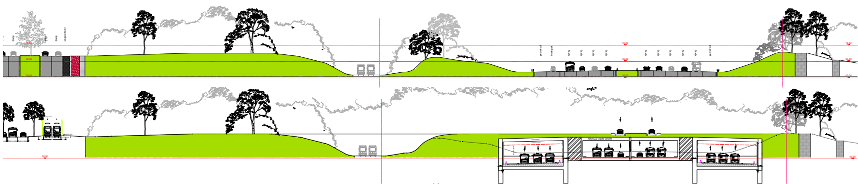
↑ Snede ter hoogte van Jan van Rijswijklaan. Bestaande toestand (boven) en ontwerp Ringland (onder)
