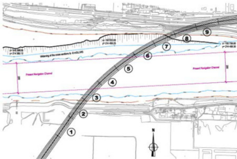
Fase I: verbreden van de vaargeul
