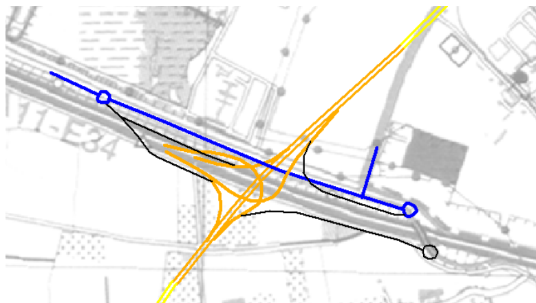
Figuur 28 Aangepaste configuratie knooppunt E34/Meccano
