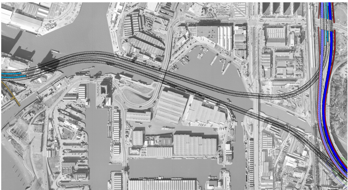
Figuur 10 Voorontwerp afgezonken tunnels onder de dokken en het Albertkanaal en cut-en-cover tunnels in de landgedeelten
