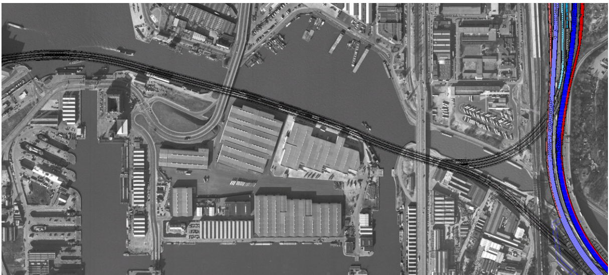
Figuur 14 Aangepast ontwerp met bovenop elkaar gelegen cut & covertunnels t.h.v. Straatsburgdok
