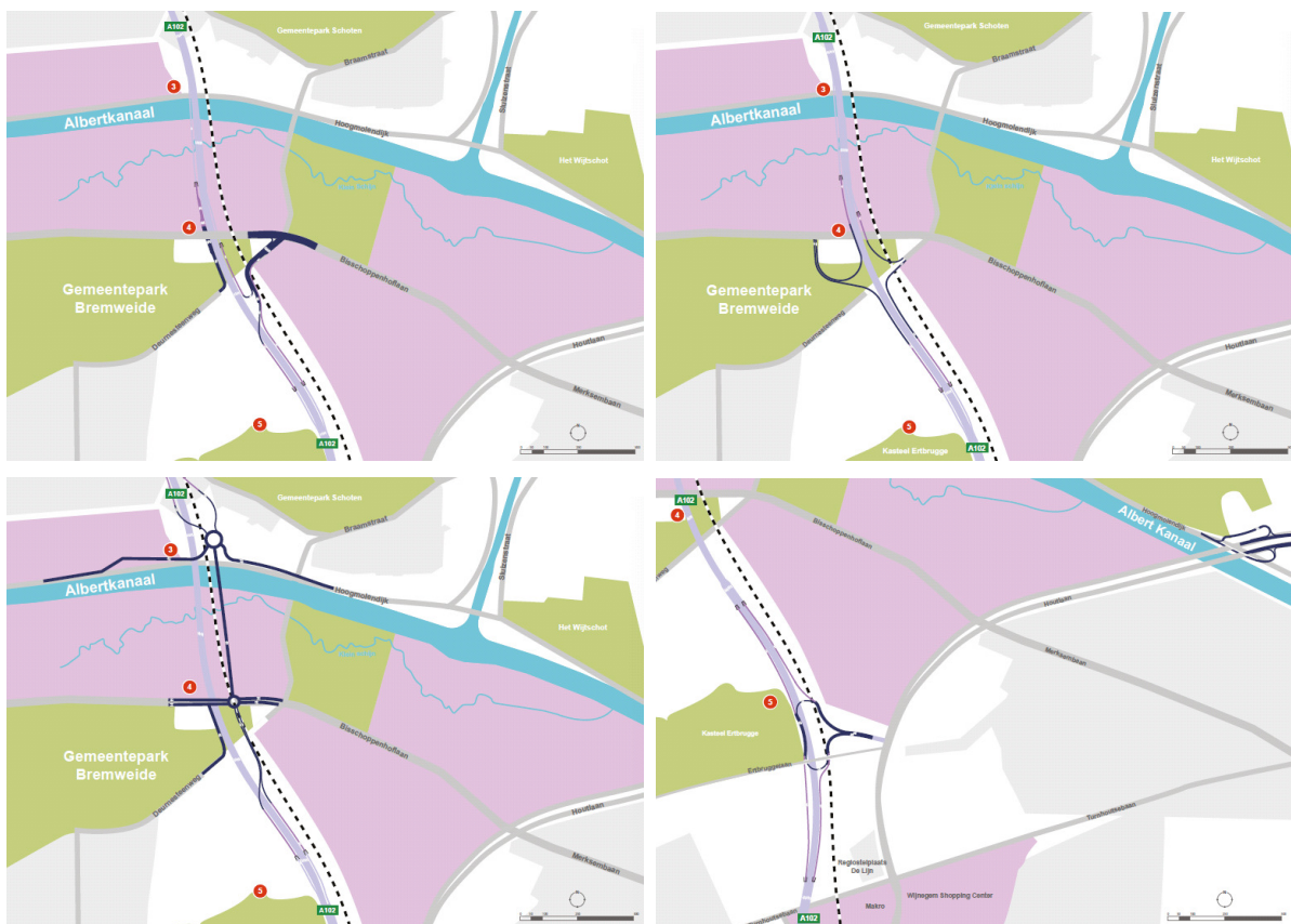
Figuur 2-10 Aansluitingscomplex op A102 t.h.v. Bisschoppenhoflaan/Houtlaan – uitvoeringsvarianten
