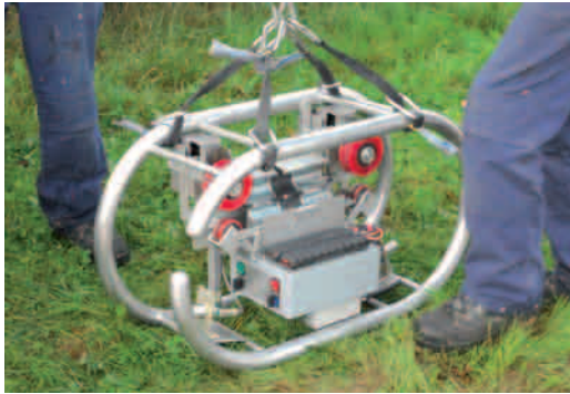
De inspectie van de geleiders van luchtlijnen met behulp van een telegeleide robot werd in 2011 met succes getest.
