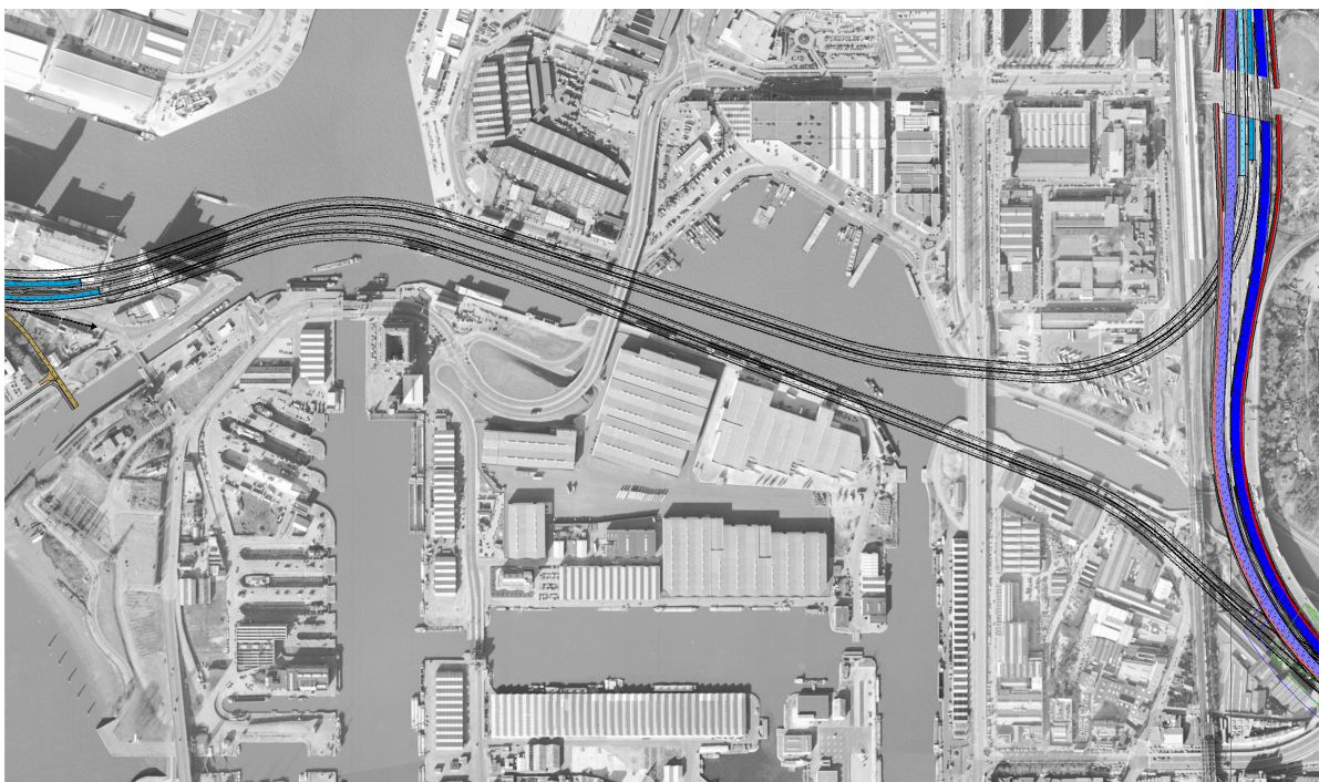
Voorontwerp afgezonken tunnels onder de dokken en het Albertkanaal en cut-en-cover tunnels in de landgedeelten
