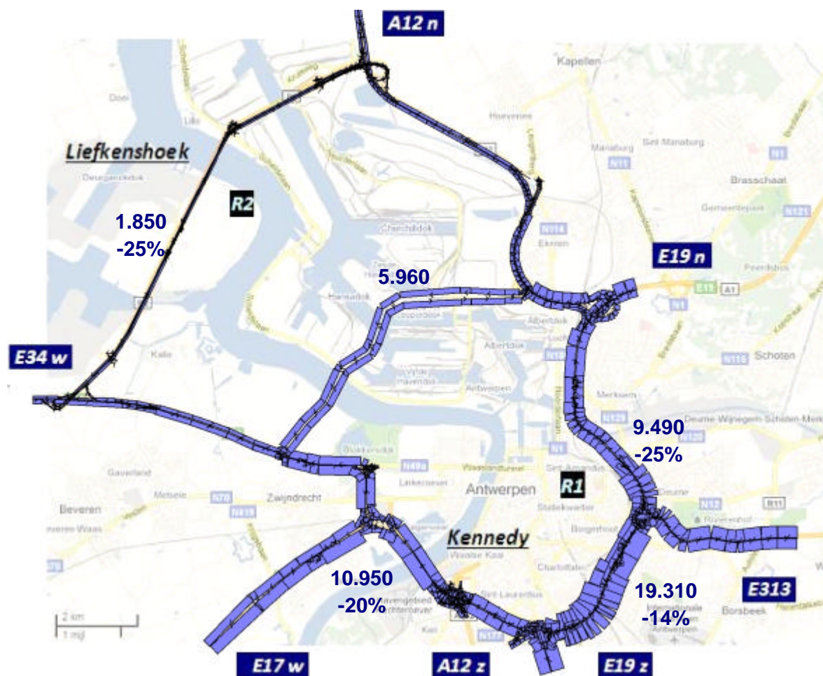
Figuur 18: Verkeersintensiteiten (pae/u) en verschil ten opzicht van referentiescenario voor een typisch ochtendspitsuur in 2020 in het scenario Meccanotracé zonder trajectheffing enkel Noordtangent
