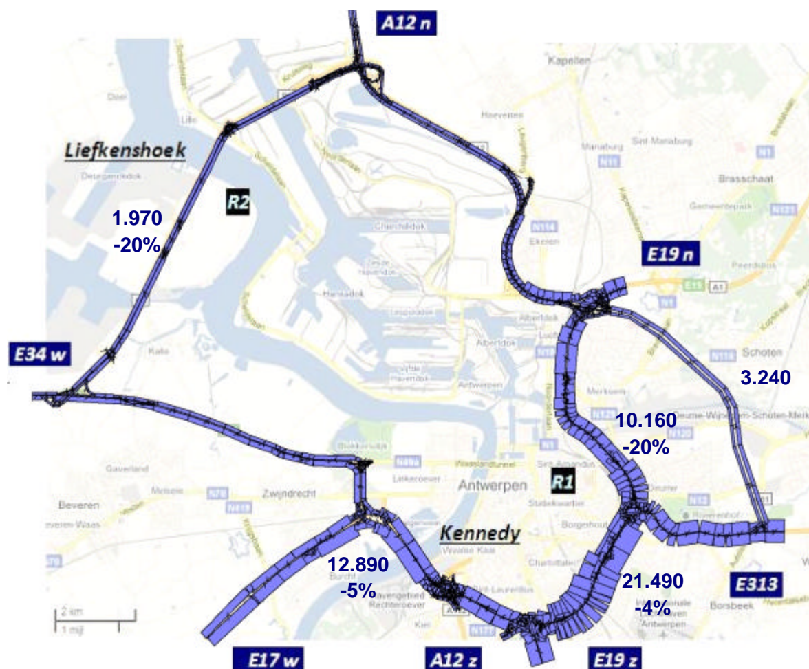
Figuur 20: Verkeersintensiteiten (pae/u) en verschil ten opzicht van referentiescenario voor een typisch ochtendspitsuur in 2020 in het scenario Meccanotracé zonder trajectheffing enkel Oosttangent
