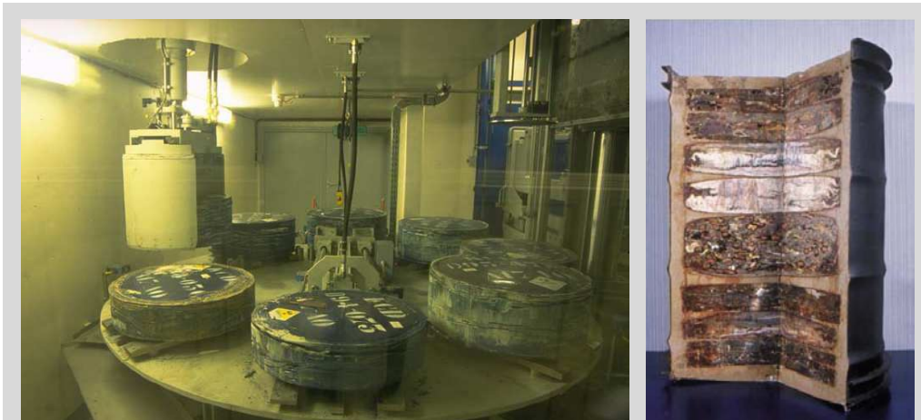
Figuur 7 – Verwerking van afval door compactie (links) en doorsnede van een container met afvalslijven afkomstig van de compactie, omhuld met cement (rechts). (bron: Belgoprocess)
