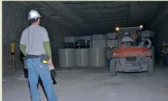
Geologische berging van militair afval in de WIPP-installatie, in een zoutlaag (New Mexico, Verenigde Staten). (bron: USDOE)
