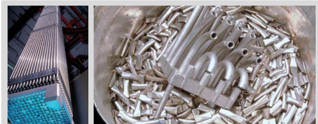
Figuur 2 – Links, een splijtstofelement; rechts, metaalafval gerecupereerd bij de opwerking van deze splijtstoffen. (bron: AREVA)
